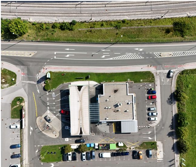
Slika 14: Na prikazani lokaciji so talne oznake za kolesarsko stezo in prehod za pešce slabo vidne, kar zmanjšuje prometno varnost. Redno vzdrževanje horizontalne in vertikalne signalizacije je ključno za jasno usmerjanje prometa, boljše preglednost in večjo varnost vseh udeležencev.
